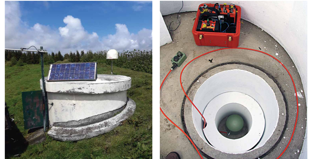
Fig. 2 – Cave sísmica (esq.) e sismómetro de banda larga (dir.) pertencentes à Rede Sísmica Permanente do CIVISA
