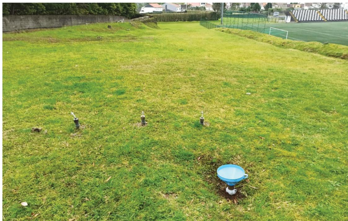
Figura 1 – Coletor de água da chuva.
