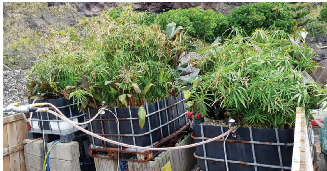
Figura 1 - Ensaio piloto de uma **zona húmida construída** para o tratamento de águas residuais
