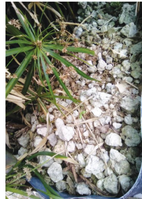
Figura 2 - Exemplo de um ensaio piloto de ZHC com pedras e plantas aquáticas como meio de enchimento.
