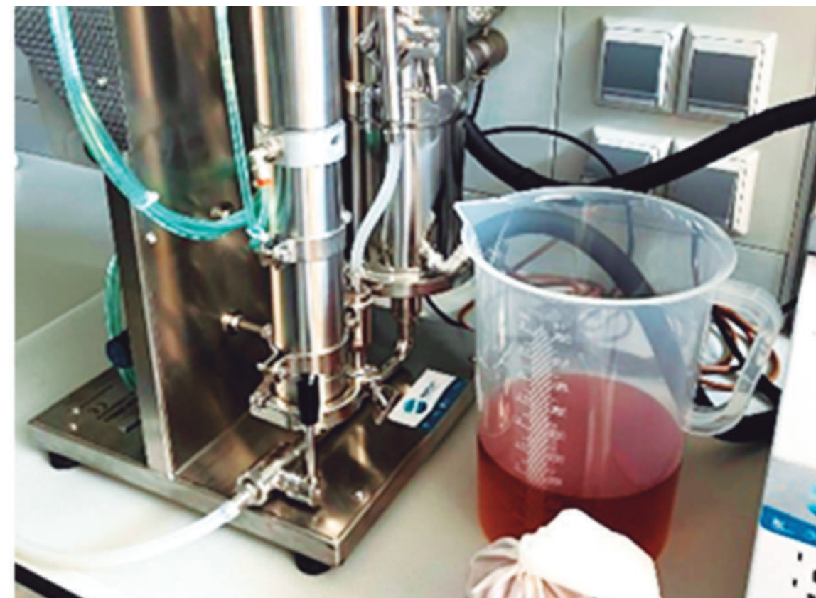
Figura 2 – Recolha do solvente resultante do processo de extração de Morella faya com Naviglio Estrattore
